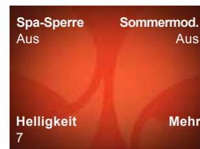
**WICHTIG:** Der Sommerzeitschalter senkt die Wassertemperatur im Whirlpool nicht unter die Umgebungslufttemperatur ab. Umgebungsbedingungen wie Luftfeuchtigkeit, Wind und Schatten beeinflussen die Temperatur des Whirlpool-Wassers.
